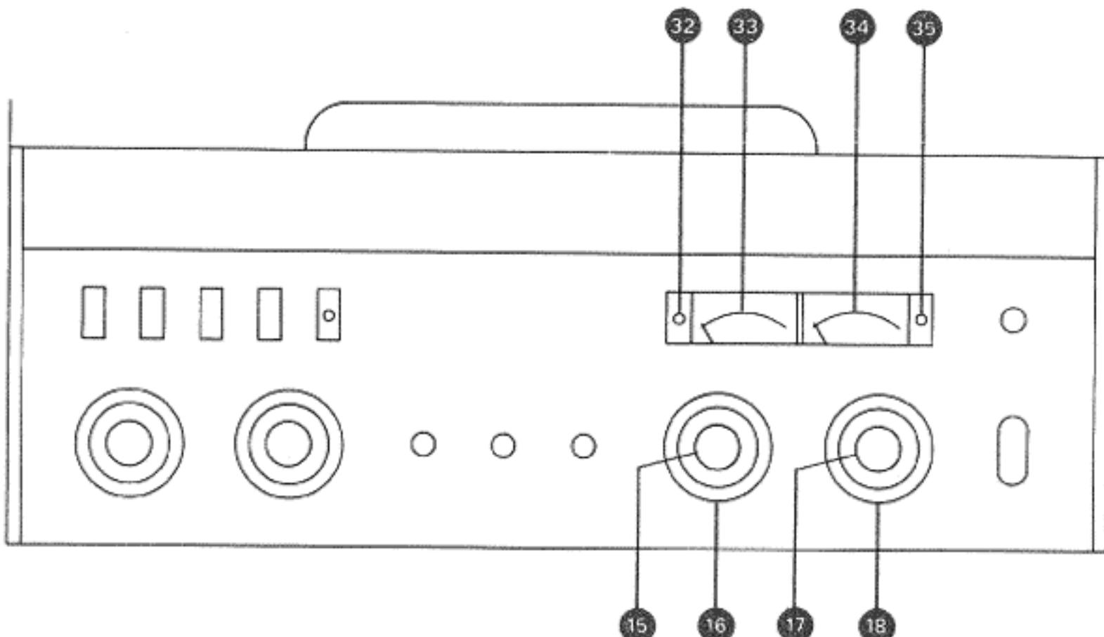
Mikrofonbuchsen stehen Cinchbuchsen (Rückseite) und Klinkenbuchsen (auf der Frontplatte) zur Verfügung; die beiden Buchsenarten sind *parallel* geschaltet.
