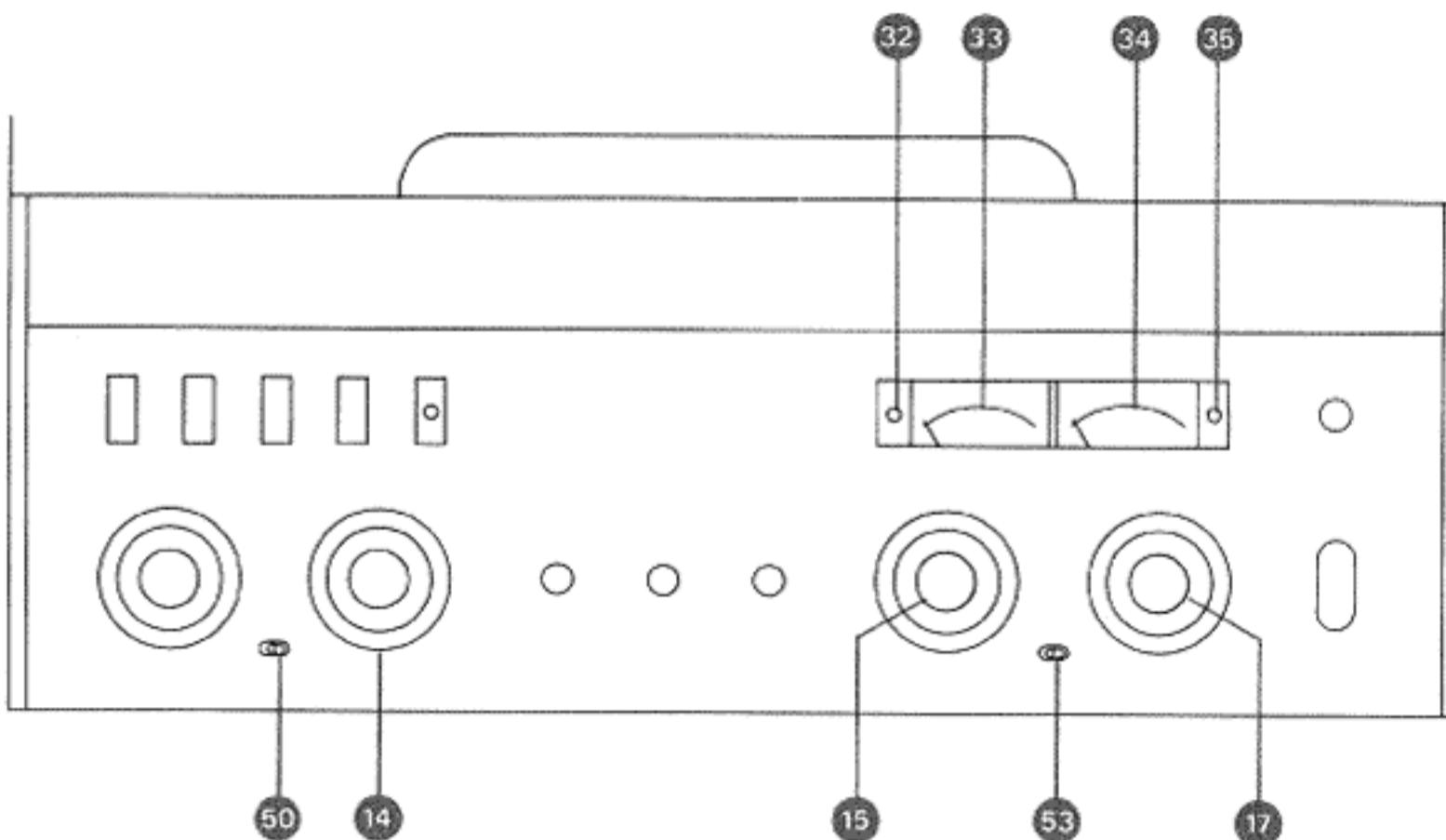
2. DOLBY-Elektronik einschalten, Schalter (50) auf Position IN schalten.
