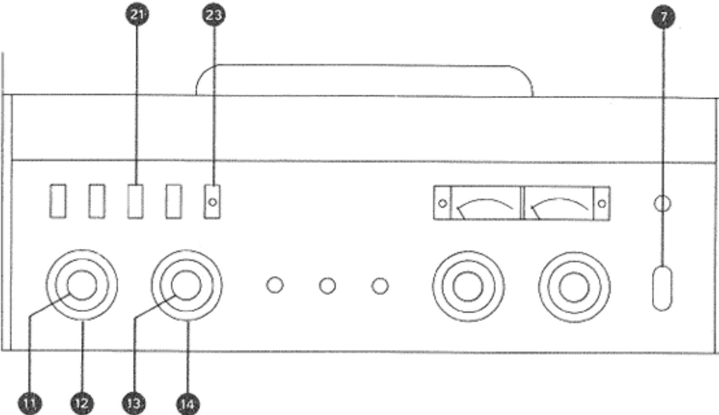
dass die VU-Meter bei Lautstärkespitzen 0 dB (100 %) anzeigen (Aufnahmebalance, siehe 2.3.). Dauernde Übersteuerung oder sehr hohe Impulsspitzen haben Verzerrungen zur Folge; bei zu schwacher Aussteuerung liegt der Rauschanteil des Tonbandes gegenüber der Aufzeichnung zu hoch. Dies wirkt sich besonders dann nachteilig aus, wenn die Aufnahme kopiert werden soll, hierbei addieren sich die Rauschspannungen.
