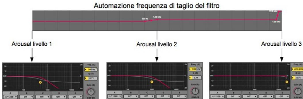
Figura 18: Comportamento del filtro passa basso con i vari livelli di arousal
