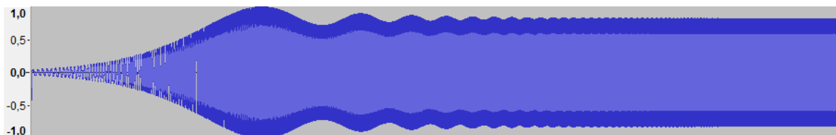
Onda risultante dall'applicazione dell'algoritmo con distanza inverse exponential \alpha=0 nel range 500.
