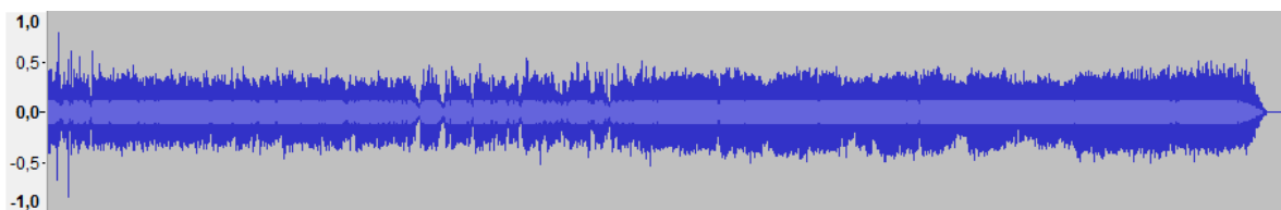
Forma d'onda del brano in seguito all'applicazione di un compressore semplice che limita l'ampiezza dell'RMS a 0.05.
