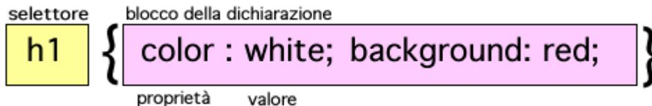
Figura 1: Struttura delle regole dei CSS
