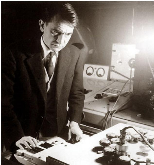
mixaggio, moduli di riverberazione, filtri, sound transposer, ne consentono la modifica dando vita ad un ampio ventaglio di sonorità allora sconosciute.
